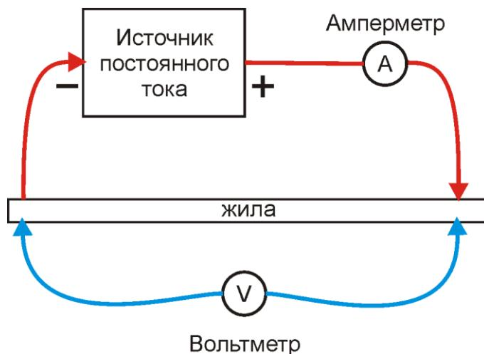
В этой схеме есть две отдельные цепи: цепь для подачи тока с амперметром и цепь измерения падения напряжения с вольтметром. Использование такого приема позволяет устранить влияние измерительных проводов и контактов.
