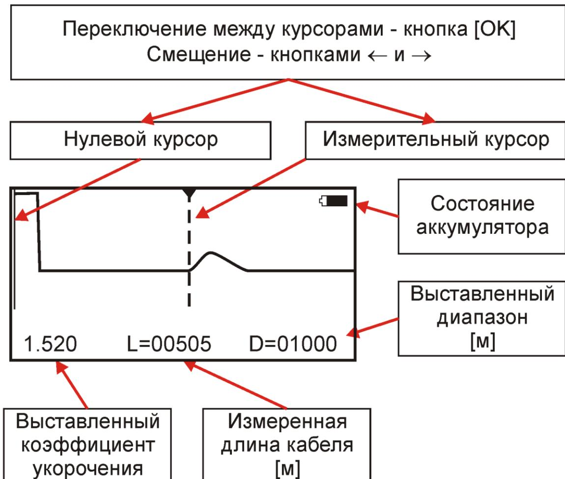
Прибор измеряет расстояние между измерительным и нулевым курсорами.
