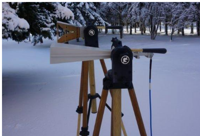
Фото 1. Антенный измерительный комплект на диэлектрических штативах ШАД-01
