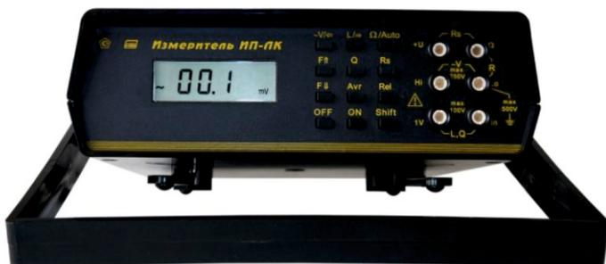
Предназначен для контроля аппаратуры автоматической локомотивной сигнализации (АЛС) на локомотиве и в условиях железнодорожного депо.
